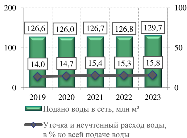
Рис. 7. Подача воды в сеть и утечка воды в системе централизованного водоснабжения края
